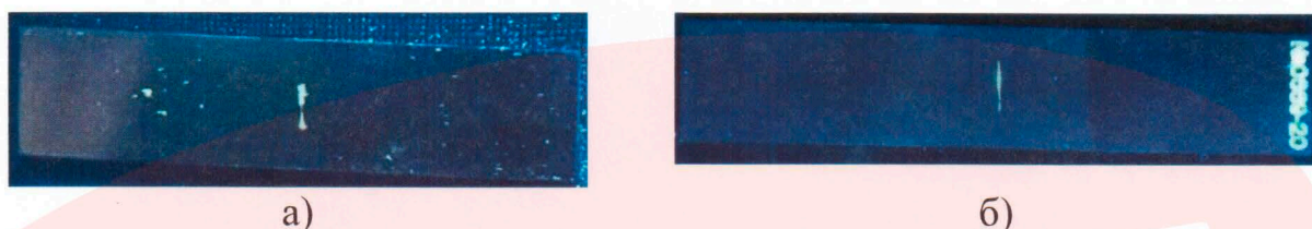
Рисунок 1 - Результаты контроля образцов с искусственными дефектами, с шириной раскрытия, соответствующей I-му классу чувствительности по режимам №1(а) и №2(б)
